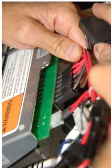
**Figure 4 Connectez le faisceau d'essai à la carte de démarrage progressif (comme on le voit depuis le dessus de la carte).**
